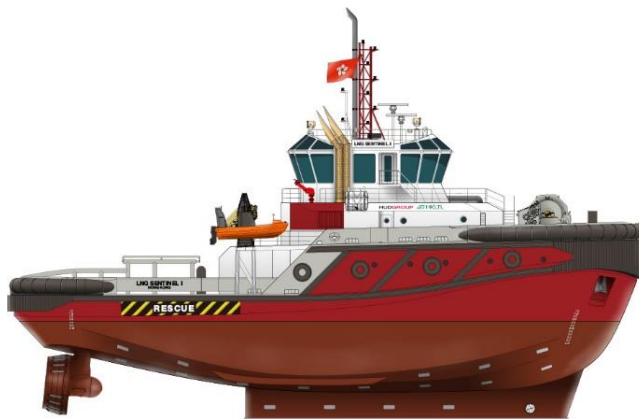
Design of RASTAR 4200 Dual Fuel LNG Tug
